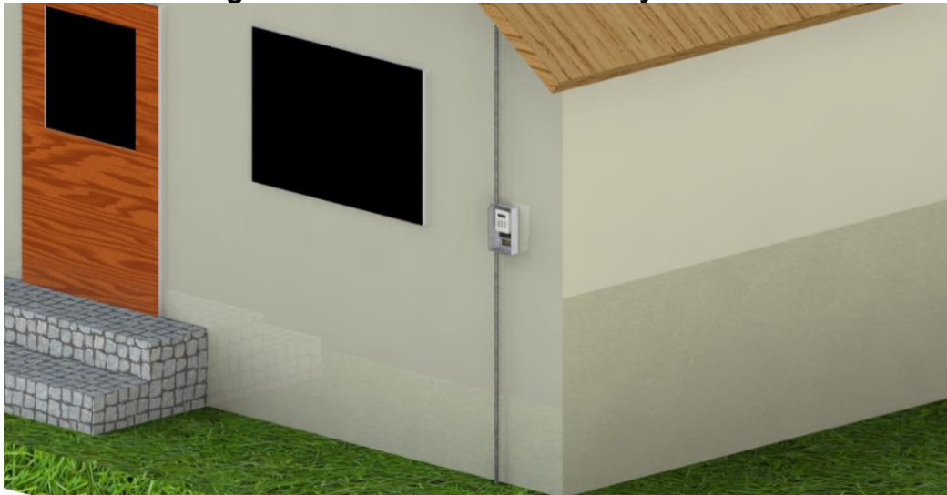
Figura 7. Fachada con medidor y ductos
